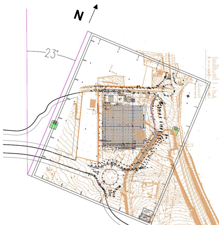
Figura 16 – Declinação de 23^\circ entre norte verdadeiro e norte de projeto - LM Loulé
